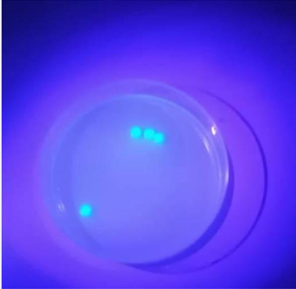
Esperimento di trasformazione batterica: viene inserito nei batteri un frammento di DNA di una medusa fluorescente e questo rende i batteri fluorescenti, modificati geneticamente in modo da diventare fluorescenti
